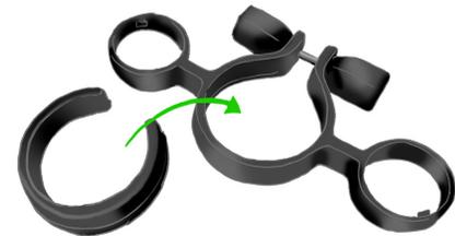
Insérer la bague de réduction dans le support.
